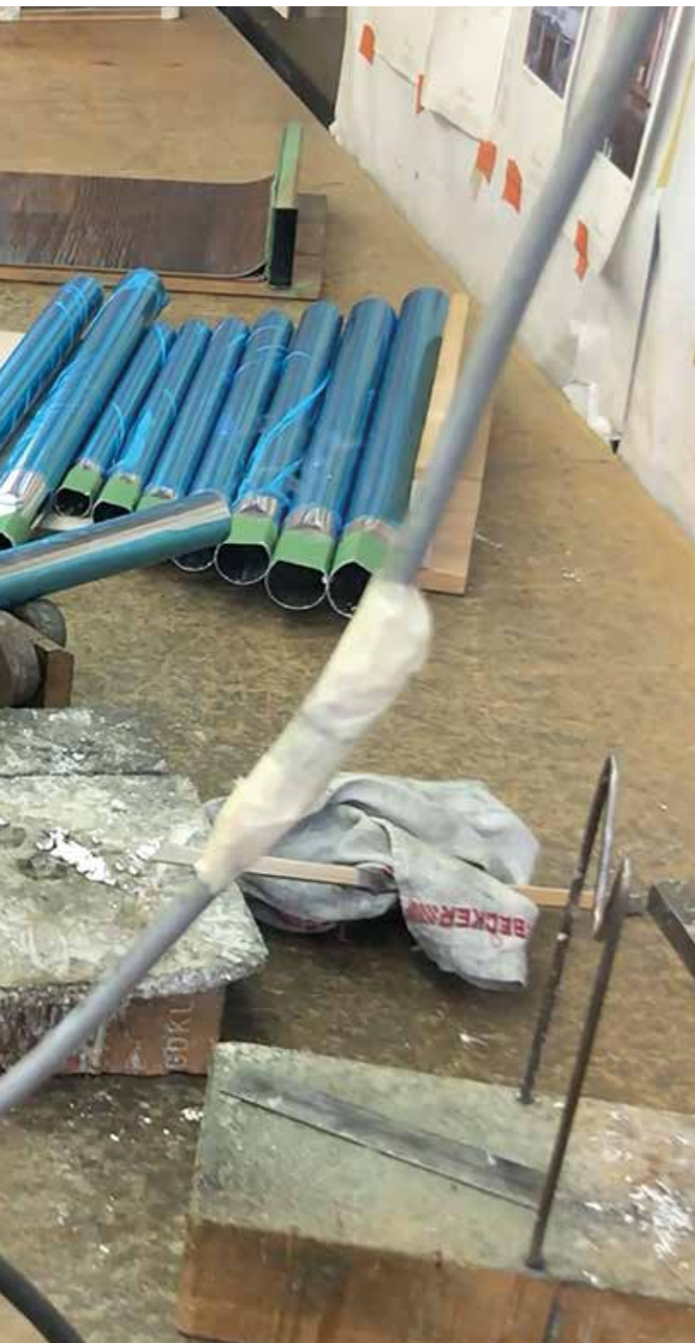
Pipmakaren Nicola Auriosa löder ihop pipdelar i orgelfabriken Rieger Orgelbau i Österrike. Ett orgelbygge kräver många timmar av specialiserat hantverk. Varje orgelpipa tillverkas för hand. Foto: Pekka Suikkanen.
